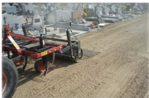
Désherbeur mécanique sur petit tracteur, système de racles + griffes disposées en quinconce.
