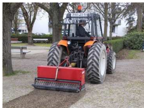
Sabot rotatif adaptable sur tracteur avec prise de force
