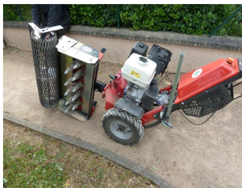
Sabot rotatif adaptable sur porte outils avec prise de force
