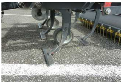
Désherbeur mécanique sur petit tracteur, système de racles + griffes disposées en quinconce.
