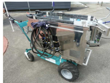
Système vapeur sèche (consommation en eau faible) et cloche pour une meilleure application. Centrale vapeur mobile à deux lances
