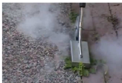
Système vapeur sèche (consommation en eau faible) et cloche pour une meilleure application. Centrale vapeur mobile à deux lances
