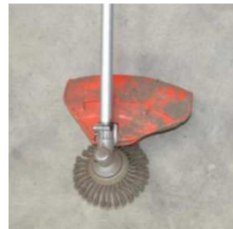
Débroussailleuse avec tête à brosse métallique
