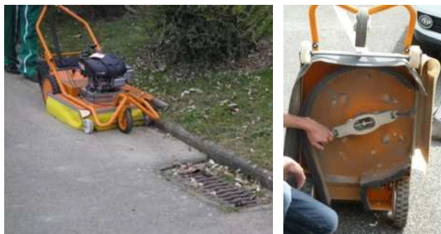
Micro-balayeuse avec système de bac de ramassage direct. Facilité de traitement des angles, fonctionnement semblable à une tondeuse à gazon.
