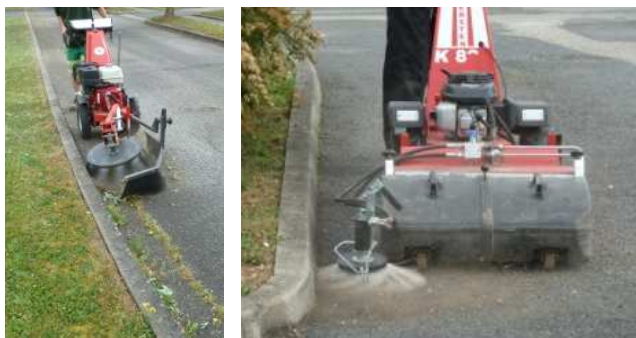
Porte-outils avec accessoire brosse de désherbage + système de ramassage. Stabilité, efficacité, nombreux accessoires adaptables (lame de déneigement, barre de coupe...)
