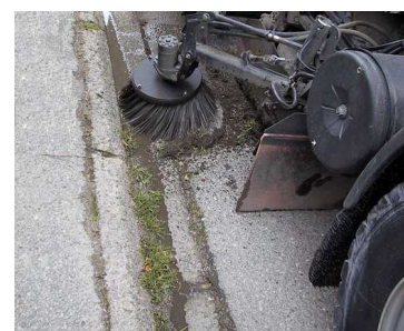
Balayeuse de voirie avec système d'aspiration
