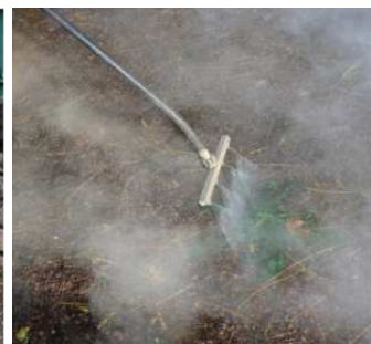
Système eau chaude avec lance d'application reliée à une station sur véhicule
