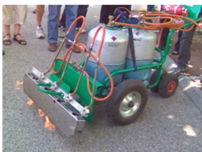
Désherbeur thermique à flamme directe sur chariot à rampe
